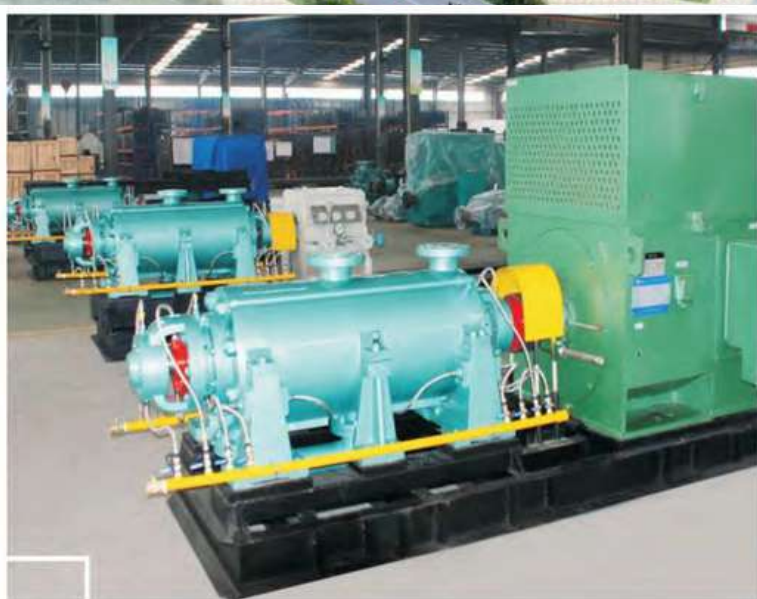
Горизонтальный многоступенчатый питательный насос котла (самобалансирующий, энергосберегающий) серии DG (P)
