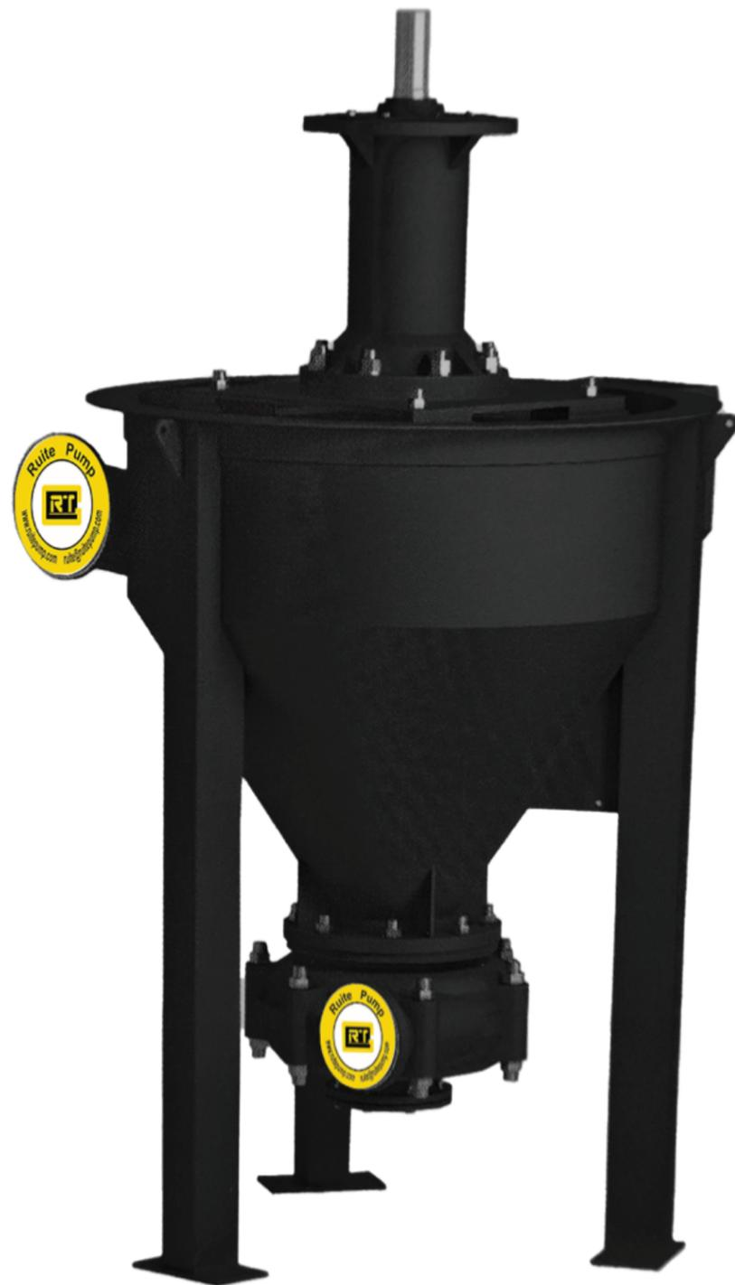
Пенные насосы серии TF имеют вертикальную конструкцию с двойным корпусом, что исключает необходимость в уплотнении. Материальный ящик может быть выслан резиной, а насос и привод могут иметь прямой или клиноременный привод. Они идеально подходит для транспортировки пенообразного шлама в металлургии, горнодобывающей, угольной, электроэнергетической и других отраслях промышленности.
