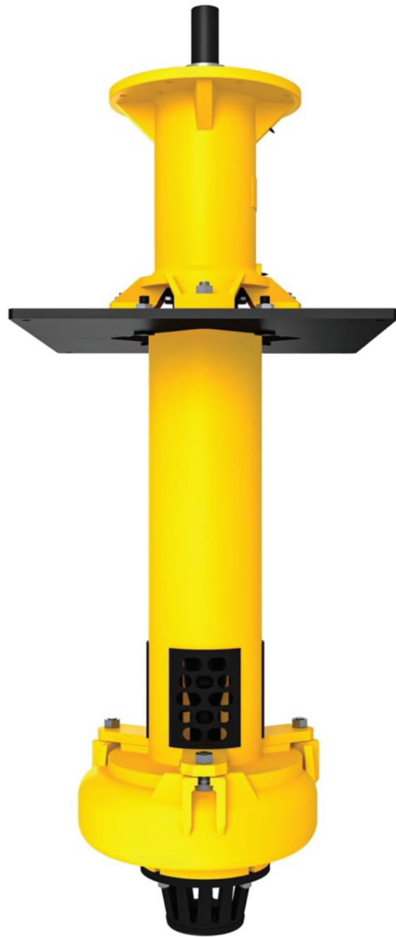
Шламовые насосы серии TSP (R) представляют собой одноступенчатую, консольную, вертикальную центробежную конструкцию одностороннего всасывания. Они идеально подходят для перекачки шлама с высокой концентрацией абразивных и крупных частиц, не требуя использования воды в уплотнении вала. Даже при недостаточном всасывании они обеспечивают нормальную работу. Эти насосы особенно эффективны для использования в различных карьерах, шахтах и системах обогащения угля.
