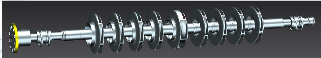
Схема деталей ротора с рабочим колесом
